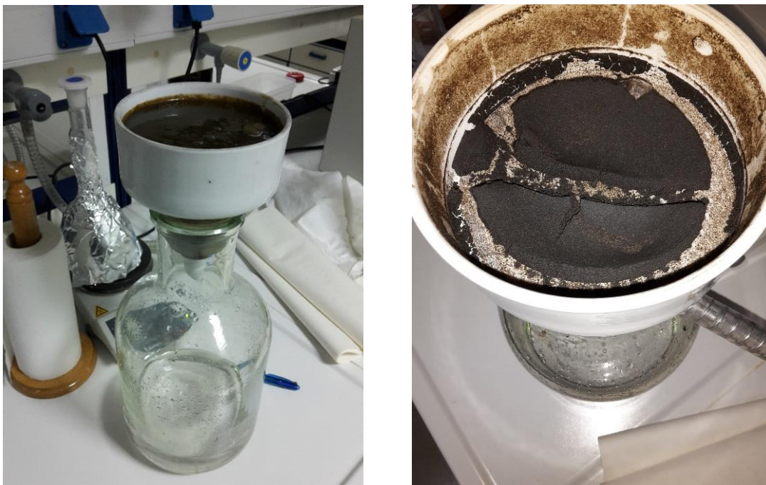
Εικόνα 5.6. Διήθηση υπό κενό σε χωνί τύπου Büchner του μίγματος της αντίδρασης με χρήση διηθητικού χαρτιού για την παραλαβή του οξειδίου του γραφίτη.
