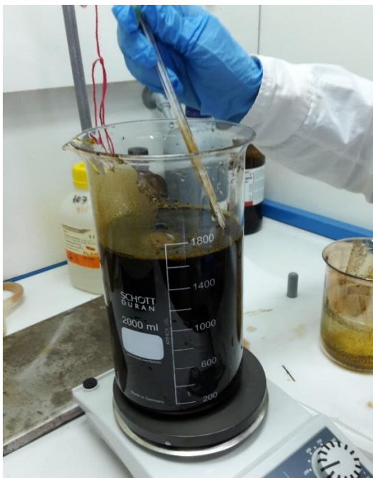
Εικόνα 5.5. Προσθήκη \text{H}_2\text{O}_2 στο μίγμα της αντίδρασης με σχηματισμό φυσαλίδων και αλλαγή του χρώματος σε κίτρινο – καφέ.
