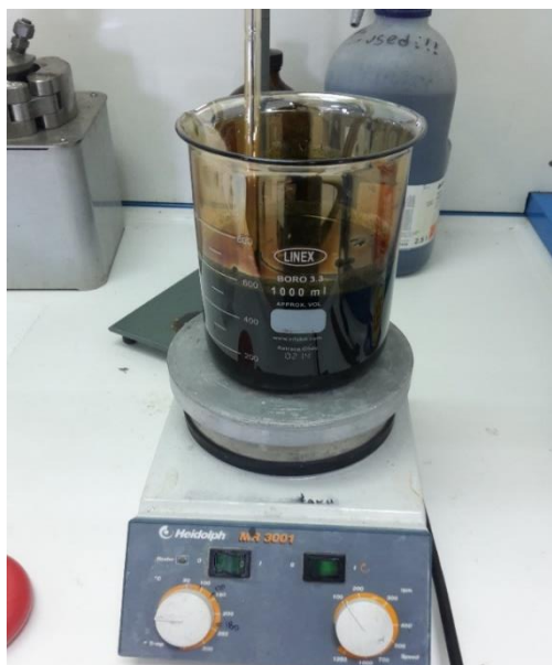
Εικόνα 5.3. Συνεχής ανάδευση του μίγματος της αντίδρασης με συνεχή παρακολούθηση της θερμοκρασίας.
