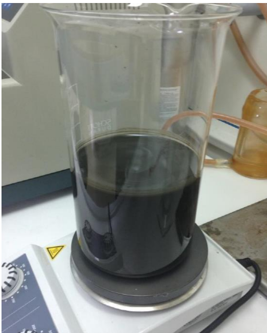
Εικόνα 5.7. Ανάδευση του οξειδίου του γραφίτη με 1 L διαλύματος HCl περιεκτικότητας 3,6% w/w.
